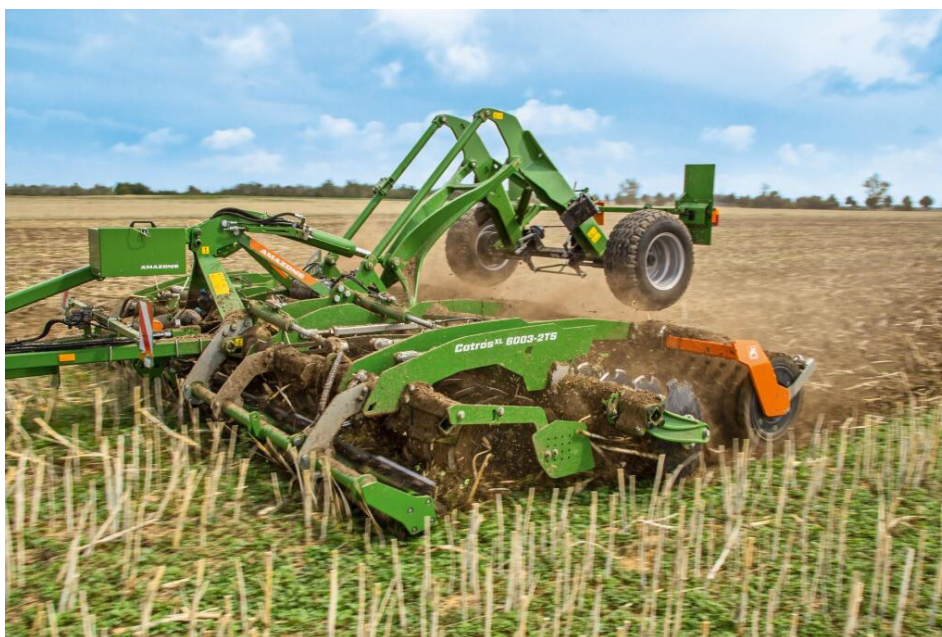
Рисунок 3 – Средняя нового поколения дисковая борона Catros sl 8003
