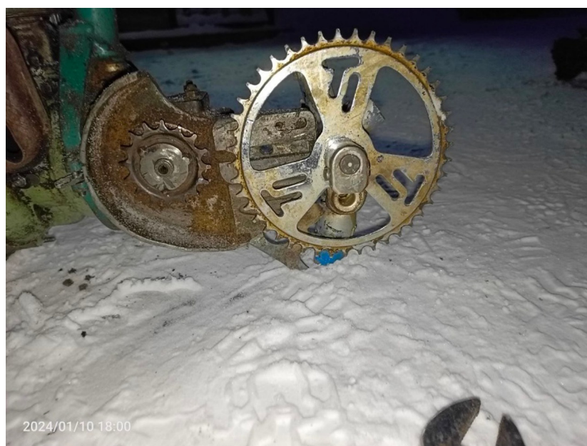
Рисунок 4 – Передача крутящего момента от бензопилы к редуктору
