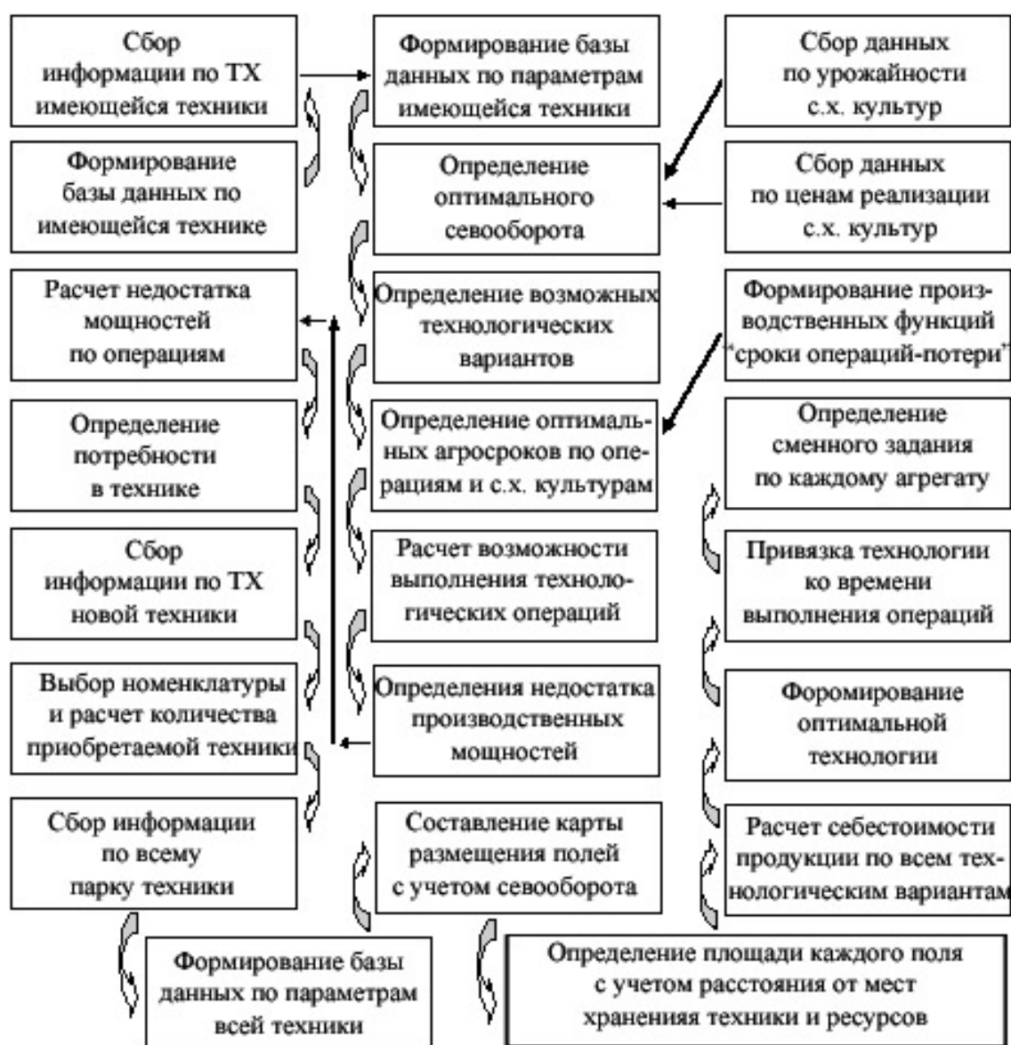
Рисунок 2 – Схема использования программы расчета технологических карт для автоматизации определения параметров сельскохозяйственных культур
