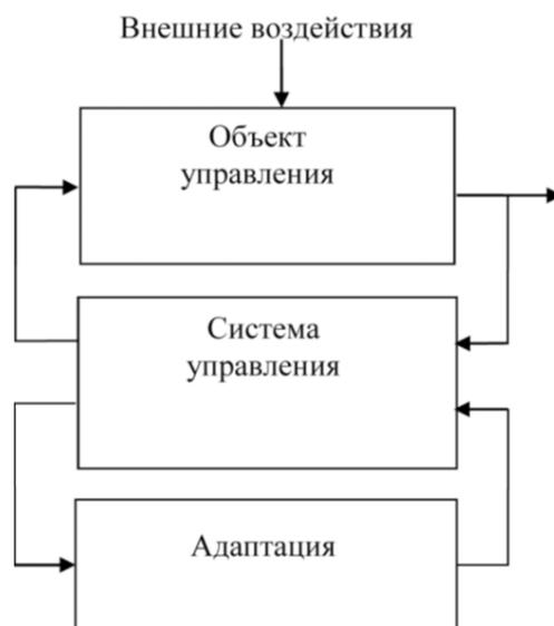
Рисунок 3 – Общая схема адаптивной системы управления
