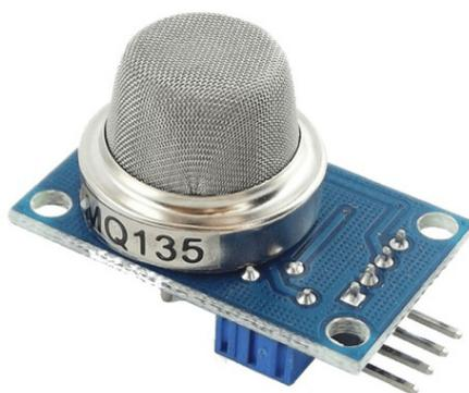
Рисунок 2 – Датчик углекислого газа MQ-135
