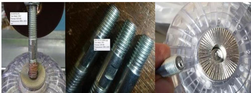
Рисунок 3 – Отказ вывод-шпилька
