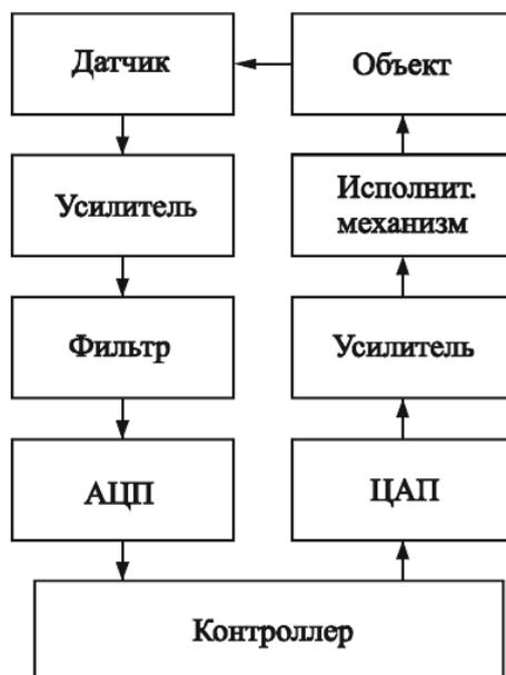
Рисунок 1 – Идеализированная схема управления объектом
