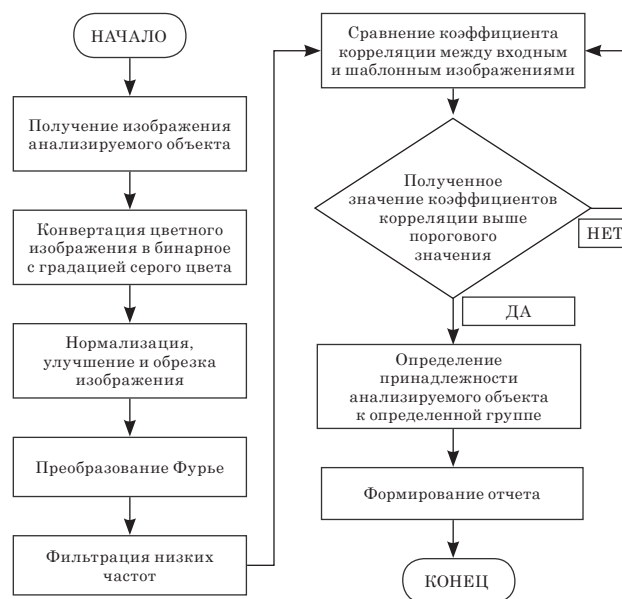
Рисунок 4 – Схема алгоритма преобразования Фурье при обнаружении дефектов семян пшеницы
