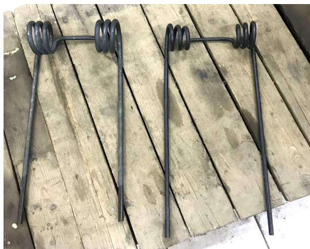
Рисунок 5 – Общий вид модифицированного пружинного пальца (слева) в сравнении со стандартным рабочим органом (справа)
