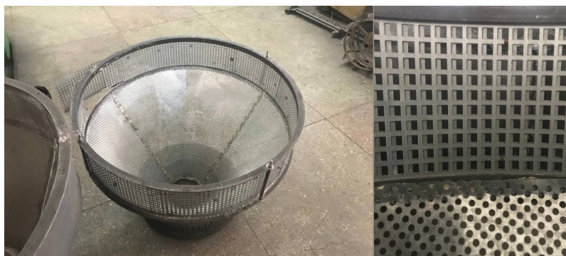
Рисунок 2 – Сепарирующее решето с квадратными отверстиями в цилиндрической части
