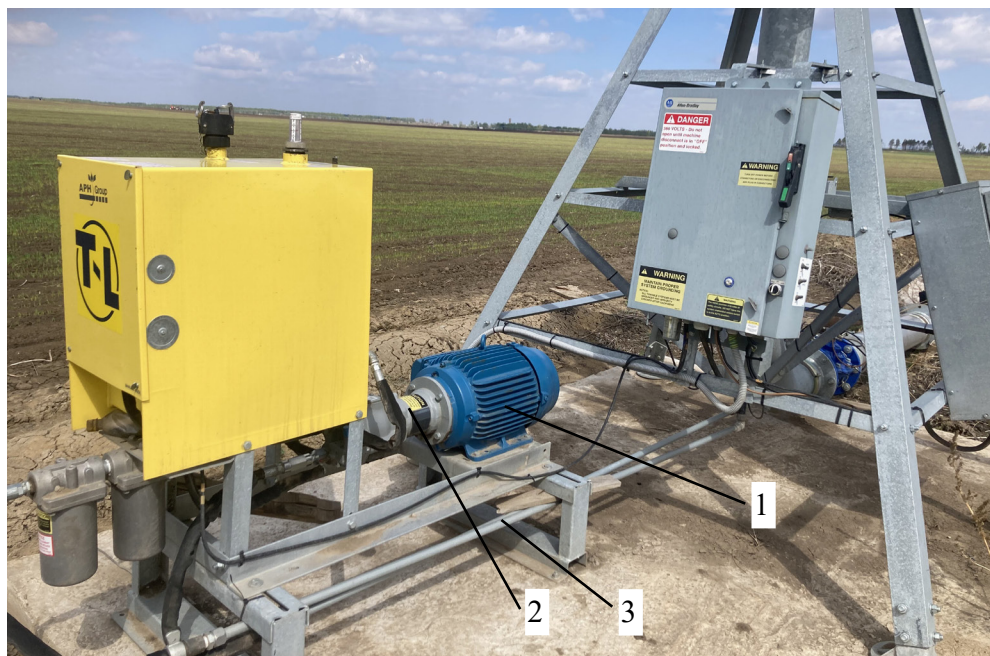
Рисунок 6 – Элементы гидравлического привода системы T-L
