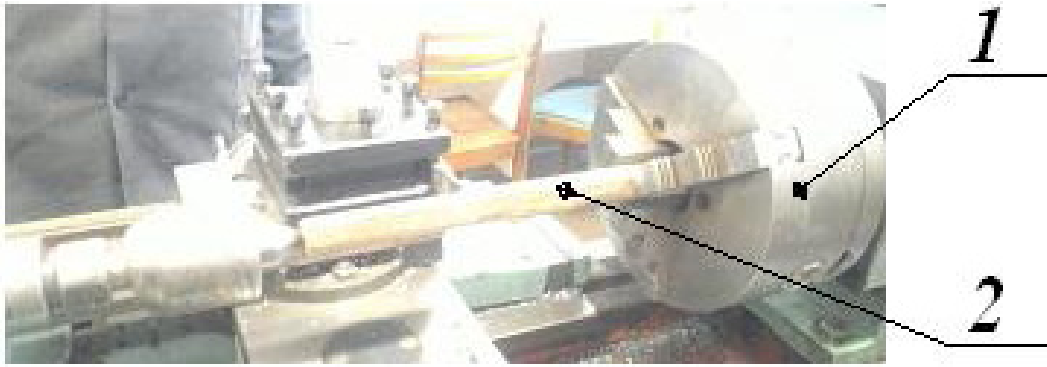
Рисунок 2 – Изготовление образцов из ППС: 1 – шпиндель станка; 2 – заготовка
