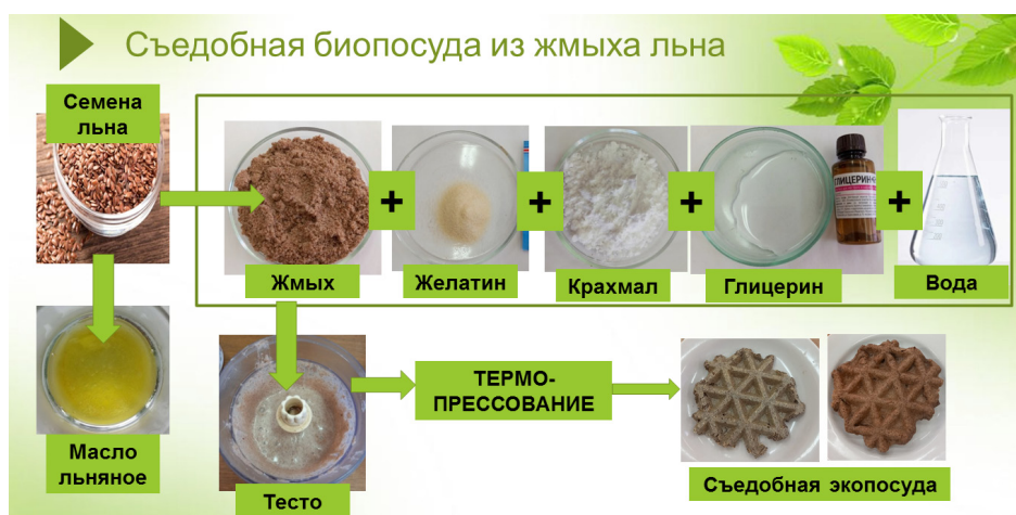
Рисунок 2 – Технологическая схема производства образцов съедобной упаковки
