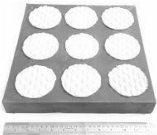
Рисунок 1 – Плитка для полов теплиц из полимерно-песчаной смеси
