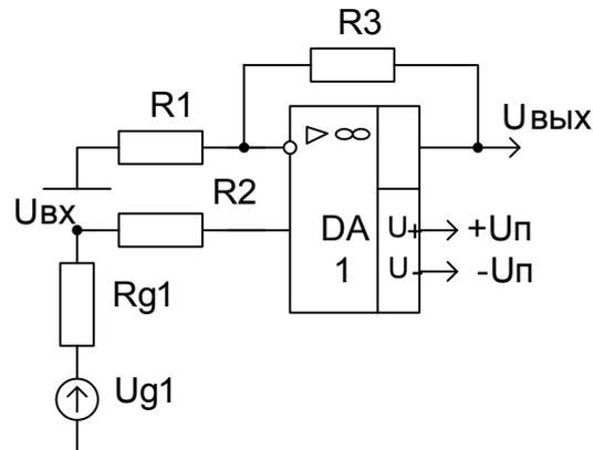
5. Рассчитать инвертирующий усилитель переменного тока на операционном усилителе. Исходные данные:  $R_{G1} = 5 \text{ кОм}$ ,  $K_U = 10$ ,  $T_{max} = 30^\circ\text{C}$ ,  $D = 24 \text{ дБ}$ ,  $F_{н} = 10 \text{ Гц}$ ,  $M_{н} = 1,3$
