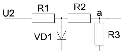
2. Рассчитать напряжение в точке а, если:  $U_2=2\text{В}$ ,  $R_1=1\text{ кОм}$ ,  $R_2=2\text{ кОм}$ ,  $R_3=3\text{ кОм}$ . Диод считать кремниевым
