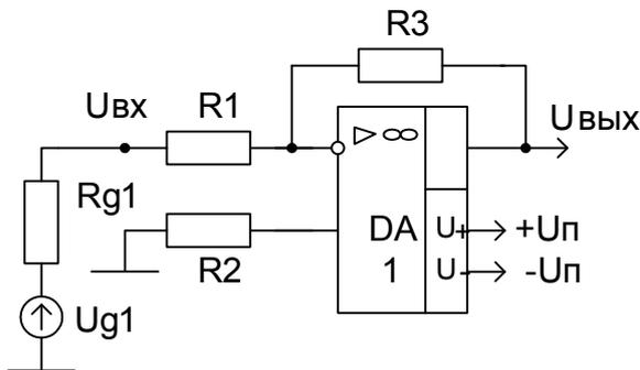
4. Рассчитать неинвертирующий усилитель постоянного тока на операционном усилителе. Исходные данные:  $R_{G1} = 10 \text{ кОм}$ ,  $K_U = 25$ ,  $T_{max} = 40^\circ\text{C}$ ,  $D = 26 \text{ дБ}$ .
