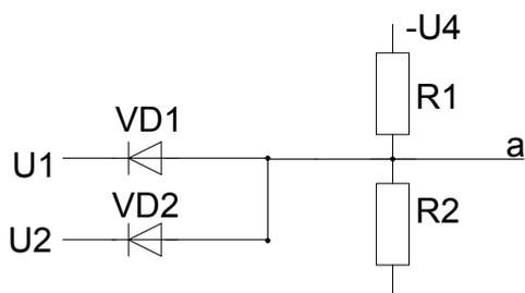
4. Рассчитать напряжение в точке а, если:  $U_8=8\text{В}$ ,  $U_1=1\text{В}$ ,  $U_2=2\text{В}$ ,  $R_1=1\text{ кОм}$ ,  $R_2=2\text{ кОм}$ . Диод считать кремниевым
