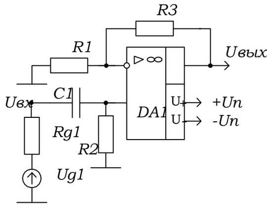
7. Рассчитать суммирующий усилитель постоянного тока на операционном усилителе. Исходные данные:  $R_{G1} = 15 \text{ кОм}$ ,  $R_G = 15 \text{ кОм}$ ,  $K_{U1} = 12$ ,  $K_{U2} = 5$ ,  $T_{max} = 40^\circ\text{C}$ ,  $D = 28 \text{ дБ}$ .
