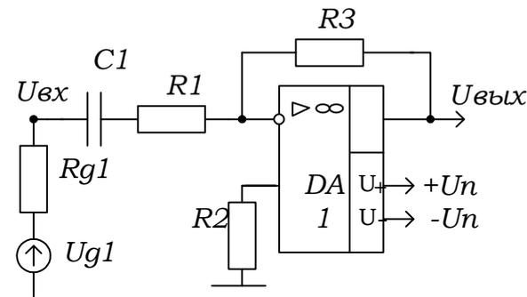
6. Рассчитать неинвертирующий усилитель переменного тока на операционном усилителе. Исходные данные:  $R_{G1} = 10 \text{ кОм}$ ,  $K_U = 25$ ,  $T_{max} = 40^\circ\text{C}$ ,  $D = 26 \text{ дБ}$ ,  $F_{н} = 20 \text{ Гц}$ ,  $M_{н} = 1,4$
