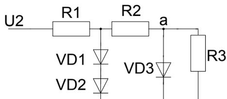
3. Рассчитать напряжение в точке а, если:  $U_4=4\text{В}$ ,  $U_1=1\text{В}$ ,  $U_2=2\text{В}$ ,  $R_1=1\text{ кОм}$ ,  $R_2=2\text{ кОм}$ . Диод считать кремниевым
