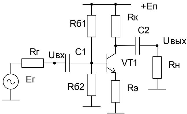
2. Рассчитать усилитель напряжения низкой частоты на биполярном транзисторе. Исходные данные:  $R_{г} = 150 \text{ Ом}$ ,  $E_{гм} = 0,25 \text{ В}$ ,  $U_{нм} = 2,0 \text{ В}$ ,  $R_{н} = 750 \text{ Ом}$ ,  $M_{н} = 1,5$ ,  $f_{н} = 30 \text{ Гц}$ .
