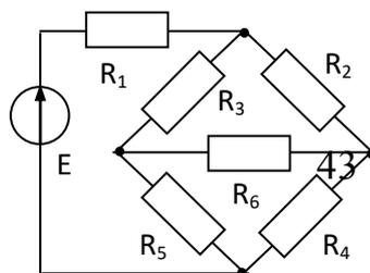
5. Рассчитать ток  $I_2$  в заданной цепи методом эквивалентного генератора.  $R_1 = R_3 = 12$  Ом,  $R_2 = R_5 = 8$  Ом,  $R_4 = 6$  Ом,  $E_1 = E_2 = 18$  В.
