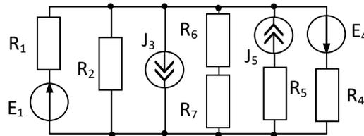
4. Рассчитать токи в элементах заданной цепи используя преобразования схем треугольника в звезду и наоборот, если  $E = 27 \text{ В}$ ,  $R_1 = 6 \text{ Ом}$ ,  $R_2 = R_4 = R_5 = R_6 = 9 \text{ Ом}$ ,  $R_3 = 12 \text{ Ом}$ .
