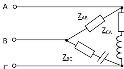
17. Определить выражение для мгновенного значения тока  $i(t)$ , потребляемого цепью, если  $\omega L = 6 \text{ Ом}$ ;  $1/\omega C = 9 \text{ Ом}$ ,  $R_1 = R_2 = 10 \text{ Ом}$ ,
