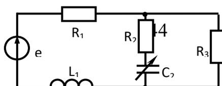
11. 7.  $U = 220 \text{ В}$ ,  $X_1 = 30 \text{ Ом}$ ,  $X_2 = 50 \text{ Ом}$ ,  $r_3 = 50 \text{ Ом}$ ,  $X_M = 10 \text{ Ом}$
