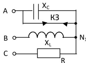
15. Рассчитать фазные напряжения и токи приемника, у которого  $R = X_L = X_C = 10 \text{ Ом}$ , если он подключен к несимметричному источнику с  $\dot{U}_A = 100 \text{ В}$ ,  $\dot{U}_B = 100e^{-j90^\circ} \text{ В}$ ,  $\dot{U}_C = 141e^{j135^\circ} \text{ В}$ . Построить топографическую диаграмму напряжений и векторную диаграмму токов, рассчитать активную мощность.
