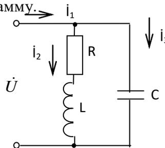
9. Дать определение резонанса напряжений: в каких цепях, при каких условиях, как проявляется? Определить ёмкость, которую нужно включить последовательно с катушкой  $R = 16$  Ом,  $L = 158$  мГн заданной цепи, чтобы в ней наступил режим резонанса напряжений при частоте 50 Гц. Рассчитать ток, мощность в цепи, напряжение на катушке. Построить диаграмму напряжений.  $U = 10$  В.
