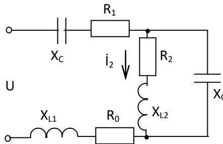
8. Дать определение резонанса токов: в каких цепях, при каких условиях, как проявляется? Рассчитать величину ёмкости, при которой в заданной цепи наступает резонанс токов, если  $R = 11,2$  Ом,  $L = 40$  мГн,  $f = 50$  Гц. Определить токи  $I_1, I_2, I_3$ , если  $U = 10$  В. Построить векторную диаграмму.
