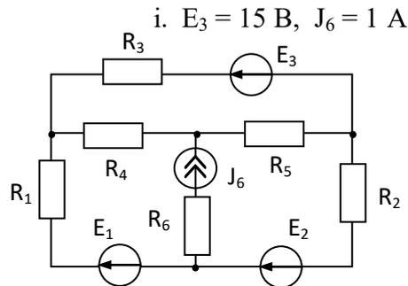
2. Методом наложения определить ток  $I_2$  в заданной цепи.  $J = 3,5 \text{ А}$ ,  $E_2 = 3 \text{ В}$ ,  $R_1 = R_5 = 2 \text{ Ом}$ ,  $R_2 = R_4 = 4 \text{ Ом}$ ,  $R_3 = 2 \text{ Ом}$
