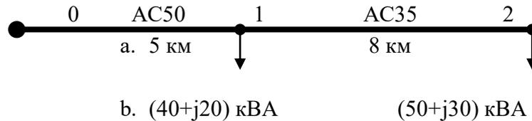
70. 10. Для приведенной линии электропередачи определить сечение провода по допустимой потере напряжения ( $F=\text{const}$  вдоль линии) при следующих исходных данных:  $\Delta U_{\text{доп}}=8\%$ ,  $U_{\text{ном}}=35$  кВ, провод марки АС. Принять коэффициент одновременности равным единице,  $X_0=0,4$  Ом/км;  $\gamma=0,032$  км/Ом\*мм<sup>2</sup>.
