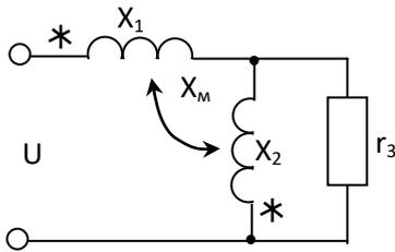
i. Вычислить ток в неразветвленной части схемы с помощью уравнений по законам Кирхгофа в комплексной форме.
