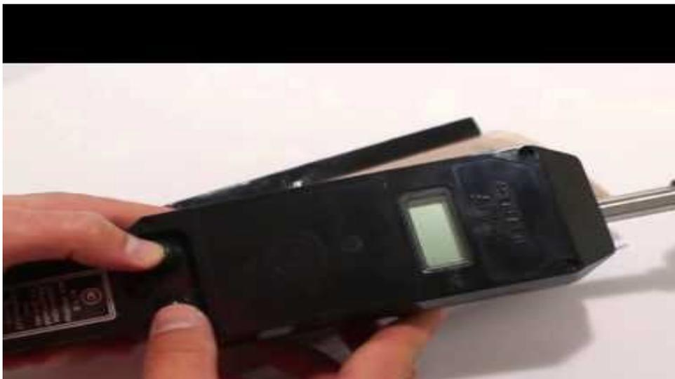
Рисунок 5 – Анемометр
