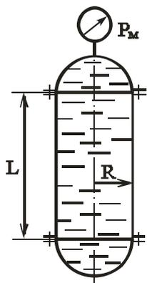
Вертикальный цилиндрический резервуар радиусом  $R=1$  м, закрытый полусферическими днищами, заполнен водой. Длина цилиндрической части  $L=5$  м. Показание манометра  $P_m=50$  кПа.
