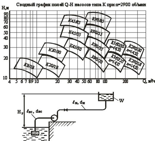
Выбрать марку насоса, обеспечивающего заполнение резервуара объемом  $W=4$  м<sup>3</sup> за время  $t=3,5$  мин, если геометрическая высота подъема  $H_г=10$  м, длина всасывающей линии  $\ell_{\text{вс}}=10$  м, диаметр  $d_{\text{вс}}=100$  мм, коэффициент  $\lambda=0,02$ , потери на местные сопротивления равны 15% от потерь по длине. Длина нагнетательной линии  $\ell_{\text{н}}=550$  м,  $d_{\text{н}}=100$  мм,  $\lambda=0,02$ . Местные потери  $h_{\text{м}}=20\%$  от  $h_{\ell}$ .
