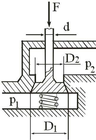
Определить силу  $F$ , которую нужно приложить к хвостовику клапана распределительного устройства объемного гидропривода для отрыва его от седла, если усилие затяжки пружины  $F_{пр} = 300 \text{ Н}$ , давление в полости подвода жидкости к клапану  $p_1 = 60 \text{ Н/см}^2$ , в полости отвода жидкости  $p_2 = 40 \text{ Н/см}^2$ .
