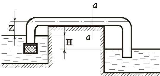
Для автоматической перекачки воды из верхнего водоема в нижний установлена труба длиной  $L=40$  м и диаметром  $d=150$  мм.
