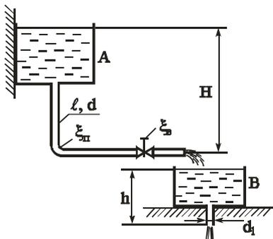
Вода сливается из бака  $A$  в бак  $B$  по трубопроводу диаметром  $d=80$  мм и длиной  $\ell=20$  м. Из бака  $B$  вода вытекает в атмосферу через внешний цилиндрический насадок диаметром  $d_1=60$  мм ( $\mu=0,82$ ). Коэффициент гидравлического трения  $\lambda=0,03$ , коэффициенты местных сопротивлений вентиля  $\xi_v=4$ , поворота  $\xi_{п}=0,3$ .
