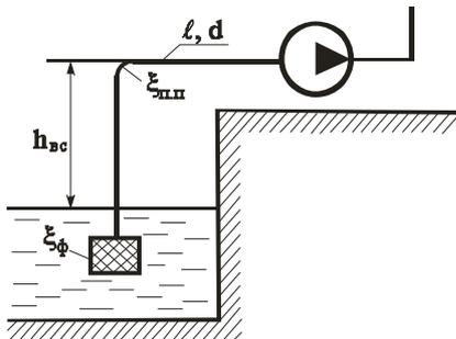
Определить максимальную величину высоты всасывания  $h_{\text{вс}}$ , если подача насоса  $Q=1$  л/сек, длина всасывающего трубопровода  $\ell=4$  м; диаметр  $d=25$  мм, коэффициент сопротивления входного фильтра  $\xi_{\phi}=5$ ; коэффициент плавного поворота  $\xi_{\text{п.п}}=0,4$ ; коэффициент  $\lambda=0,03$ . Максимально допустимый вакуум перед входом в насос  $P_{\text{вак}}=0,08$  МПа.  $\gamma=9810$  Н/м<sup>3</sup>
