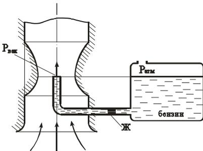
Определить расход бензина через жиклер Ж карбюратора диаметром  $d=1,2$  мм, если коэффициент расхода жиклера  $\mu=0,8$ . Сопротивлением бензотрубки пренебречь. Давление в поплавковой камере атмосферное. Разрежение (вакуум) в горловине диффузора  $P_{\text{вак}}=18$  кПа. Плотность бензина  $\rho_б=750$  кг/м<sup>3</sup>.
