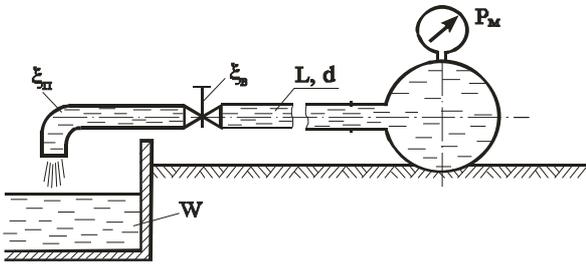
Наполнение бассейна из магистрали с заданным давлением  $P_M=2,5 \text{ кгс/см}^2$  производится по горизонтальной трубе, снабженной вентилям ( $\xi_B=4$ ) и отводом ( $\xi_{от}=0,3$ ).
