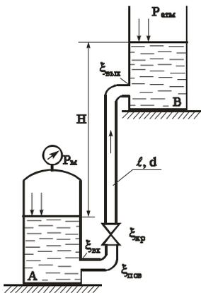
Вода подается из бака А автоматической водокачки в открытый верхний бак В по трубопроводу длиной  $\ell = 20 \text{ м}$ , диаметром  $d = 100 \text{ мм}$ . Превышение уровня воды в баке В над уровнем воды в баке А –  $H = 6 \text{ м}$ .
