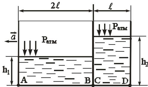
Открытый призматический сосуд длиной  $3l=3$  м и шириной  $b=1$  м разделен плоской перегородкой на два отсека, заполненные водой до высот  $h_1=1$  м,  $h_2=1,75$  м.
