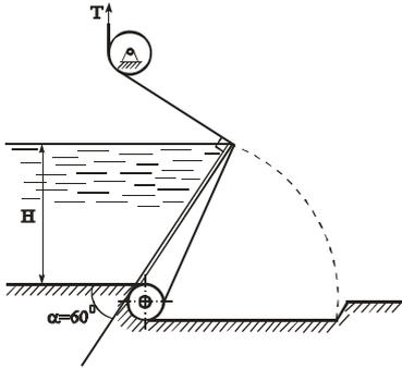
Плоский клапанный затвор шириной  $B=10$  м создает подпор воды высотой  $H=2,5$  м. Угол наклона затвора к горизонту  $\alpha=60^\circ$ . Определить суммарную силу натяжения тросов  $T$  при удержании затвора в заданном положении.
