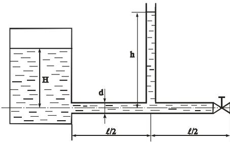
Из бака, в котором поддерживается постоянный уровень  $H=5 \text{ м}$ , вода вытекает по горизонтальной стальной трубе (длиной  $\ell=100 \text{ м}$ , диаметром  $d=100 \text{ мм}$ , с толщиной стенки  $5 \text{ мм}$ , коэффициент гидравлического трения  $\lambda=0,03$ ). На конце трубы имеется задвижка ( $\xi=5$ ).
