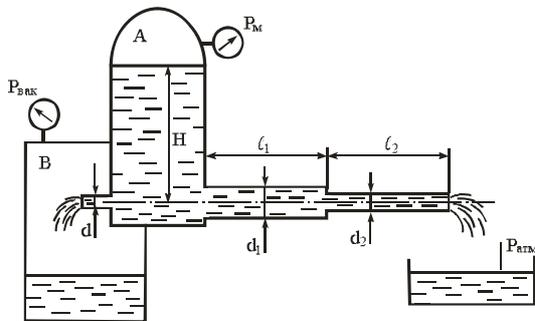
Из резервуара А, в котором поддерживается постоянным избыточное давление  $P_M=0,05$  МПа и уровень воды  $H=5$  м, происходит одновременное истечение через трубопровод в атмосферу и через цилиндрический насадок в резервуар В, где поддерживается постоянный вакуум  $P_{\text{вак}}=0,08$  МПа. Трубопровод имеет два участка с размерами  $l_1=l_2=5$  м;  $d_1=100$  мм;  $d_2=50$  мм. Коэффициент гидравлического трения принять равным  $\lambda=0,03$ .
