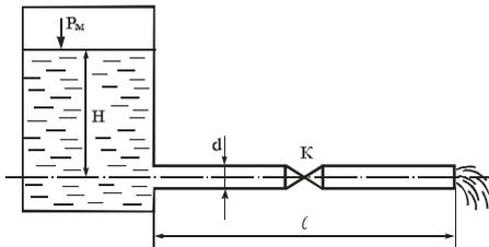
По трубе постоянного сечения из закрытого резервуара вода вытекает в атмосферу под напором  $H$ . На свободной поверхности в резервуаре создано избыточное давление  $P_m$ . На середине длины трубы установлен кран  $K$ .
