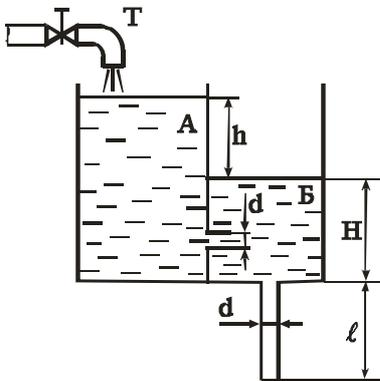
Вода по трубе Т попадает в бак А в количестве  $Q=10$  л/с. Далее вода из бака А поступает в бак Б через внешний цилиндрический насадок диаметром  $d=50$  мм ( $\mu_c=0,82$ ), а затем через трубу того же диаметра  $d$  и длиной  $\ell=2$  м вытекает в атмосферу. Принять коэффициент гидравлического трения  $\lambda=0,03$ .
