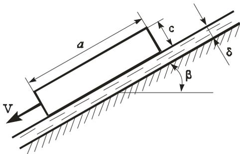
Определить скорость скольжения  $V$  прямоугольной пластины с размерами  $a \times b \times c=500 \times 300 \times 20$  мм по наклонной плоскости под углом  $\beta=30^\circ$ , если между пластиной и плоскостью находится слой масла толщиной  $\delta=1$  мм. Материал пластины – алюминий (плотность  $\rho_{Al}=2700$  кг/м<sup>3</sup>). Коэффициент кинематической вязкости и плотность масла принять  $\nu=0,28$  см<sup>2</sup>/с,  $\rho=880$  кг/м<sup>3</sup>).
