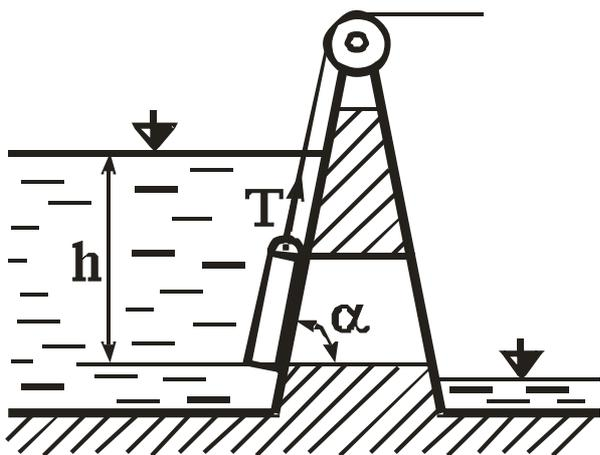
Прямоугольный щит перекрывает отверстие в теле плотины. Щит установлен с углом наклона  $\alpha=60^\circ$ , имеет высоту  $a=1,2$  м, ширину  $b=1,5$  м. Нижняя кромка щита находится в воде на глубине  $h=10$  м, масса щита  $m=2$  т.
