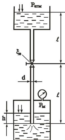
Вода (плотность  $\rho=1000 \text{ кг/м}^3$ ) подается в открытый верхний бак по вертикальной трубе ( $d=25 \text{ мм}$ ;  $\ell=3 \text{ м}$ ;  $h=0,5 \text{ м}$ ) за счет избыточного давления  $P_M$  в нижнем закрытом баке.
