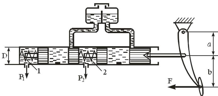
На рисунке представлена схема главного тормозного цилиндра автомобиля в момент торможения.
