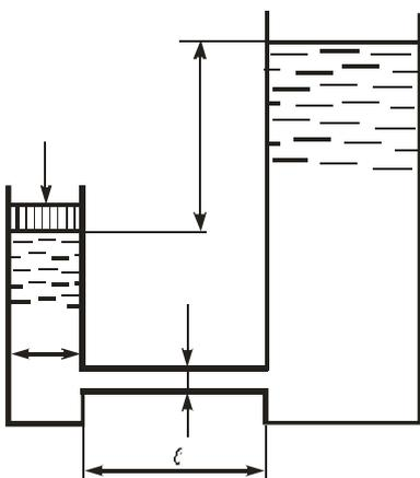
Поршень диаметром  $D = 0,1 \text{ м}$  движется равномерно вниз в цилиндре, подавая воду в открытый резервуар с постоянным уровнем. Диаметр трубопровода  $d = 10 \text{ мм}$ , его длина  $\ell = 5 \text{ м}$ . Когда поршень находится ниже уровня жидкости в резервуаре на  $H = 5 \text{ м}$ , потребная для его перемещения сила равна  $F = 50 \text{ кгс}$ .
