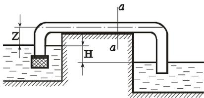
Для автоматической перекачки воды из верхнего водоема в нижний установлена сифонная труба длиной  $l=30$  м и диаметром  $d=200$  мм.
