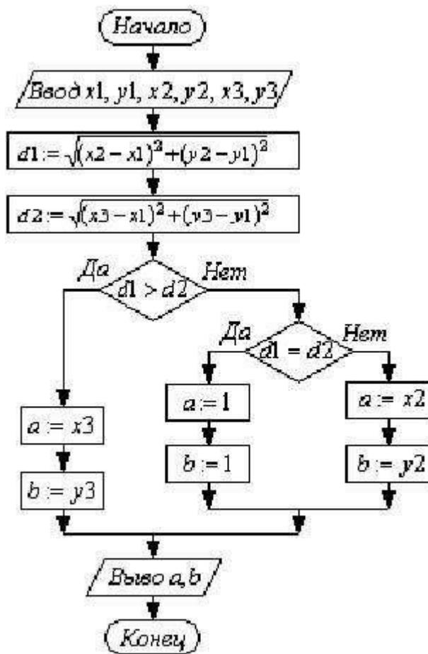
В результате выполнения алгоритма при исходных данных  $x1 = 2, y1 = -2, x2 = -1, y2 = -2, x3 = 2, y3 = 2$  значение переменной  $b$  будет равно?
