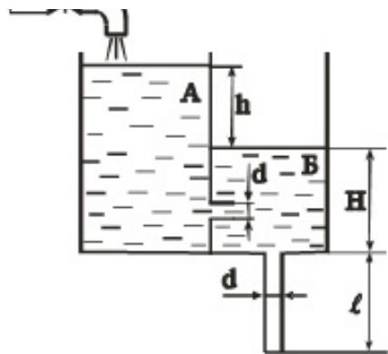
51. Определить расход бензина через жиклер Ж карбюратора диаметром  $d=1,2$  мм, если коэффициент расхода жиклера  $\mu=0,8$ . Сопротивлением бензотрубки пренебречь. Давление в поплавковой камере атмосферное. Разрежение (вакуум) в горловине диффузора  $P_{вак}=18$  кПа. Плотность бензина  $\rho_b=750$  кг/м<sup>3</sup>.
