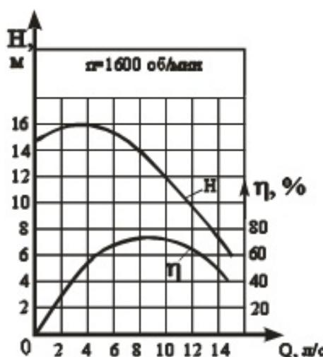
17. Всасывающий трубопровод насоса имеет длину  $l=5$  м и диаметр  $d=32$  мм. Высота всасывания насоса  $h=0,8$  м, атмосферное давление  $P_{атм}=100$  кПа. Насос подает минеральное масло при расходе  $Q=50$  л/мин ( $\nu=0,01$  см<sup>2</sup>/сек,  $\rho=890$  кг/м<sup>3</sup>). Коэффициенты местных сопротивлений:  $\xi_{пл.поворот}=0,1$ ;  $\xi_{вент}=4,5$ ;  $\xi_{фильтра}=10$ . Определить абсолютное давление  $P_2$  на входе в насос.
