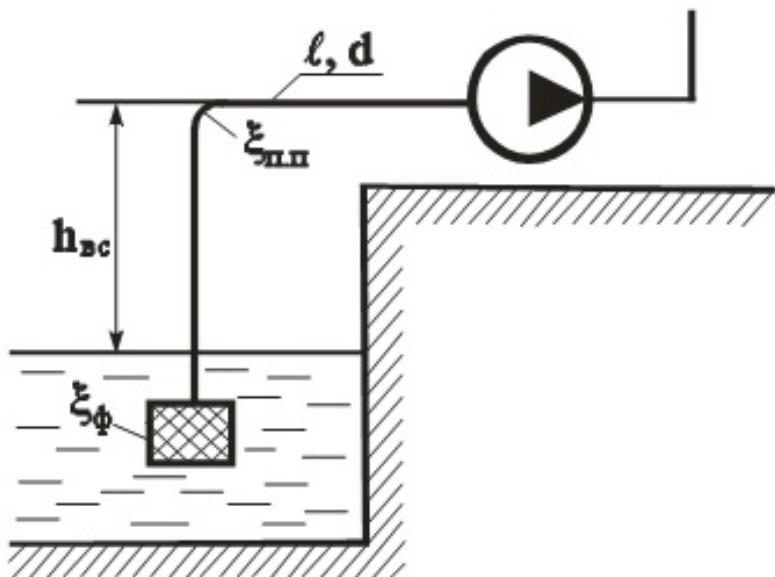
16. Выбрать марку насоса, обеспечивающего заполнение резервуара объемом  $W=4$  м<sup>3</sup> за время  $t=3,5$  мин, если геометрическая высота подъема  $H_g=10$  м, длина всасывающей линии  $l_{bc}=10$  м, диаметр  $d_{bc}=100$  мм, коэффициент  $\lambda=0,02$ , потери на местные сопротивления равны 15% от потерь по длине. Длина нагнетательной линии  $l_h=550$  м,  $d_h=100$  мм,  $\lambda=0,02$ . Местные потери  $h_m=20\%$  от  $h_l$ .
