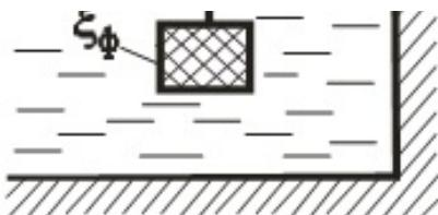
53. Выбрать марку насоса, обеспечивающего заполнение резервуара объемом  $W=4 \text{ м}^3$  за время  $t=3,5 \text{ мин}$ , если геометрическая высота подъема  $H_r=10 \text{ м}$ , длина всасывающей линии  $l_{bc}=10 \text{ м}$ , диаметр  $d_{bc}=100 \text{ мм}$ , коэффициент  $\lambda=0,02$ , потери на местные сопротивления равны 15% от потерь по длине. Длина нагнетательной линии  $l_h=550 \text{ м}$ ,  $d_h=100 \text{ мм}$ ,  $\lambda=0,02$ . Местные потери  $h_m=20\%$  от  $h_l$ .
