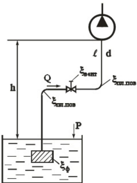
41. Наполнение бассейна из магистрали с заданным давлением  $P_m=2,5$  кгс/см<sup>2</sup> производится по горизонтальной трубе, снабженной вентилем ( $\xi_v=4$ ) и отводом ( $\xi_p=0,3$ ). Определить диаметр трубопровода, который обеспечит наполнение бассейна объемом  $W=36$  м<sup>3</sup> за время  $t=30$  мин. Потерями по длине пренебречь.  $\gamma=9810$  Н/м<sup>3</sup>.
