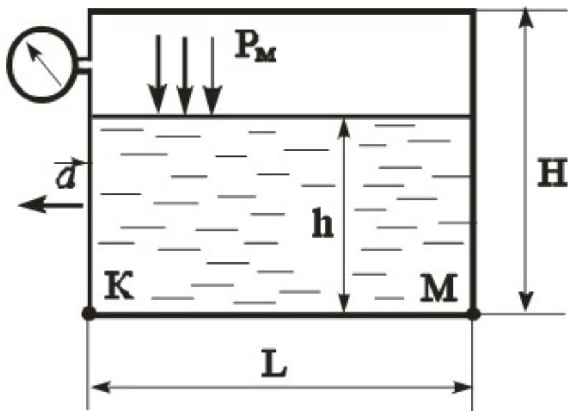
13. Выбрать марку насоса, обеспечивающего заполнение резервуара объемом  $W=4 \text{ м}^3$  за время  $t=3,5 \text{ мин}$ , если геометрическая высота подъема  $H_g=10 \text{ м}$ , длина всасывающей линии  $l_{bc}=10 \text{ м}$ , диаметр  $d_{bc}=100 \text{ мм}$ , коэффициент  $\lambda=0,02$ , потери на местные сопротивления равны 15% от потерь по длине. Длина нагнетательной линии  $l_h=550 \text{ м}$ ,  $d_h=100 \text{ мм}$ ,  $\lambda=0,02$ . Местные потери  $h_m=20\%$  от  $h_l$ .
