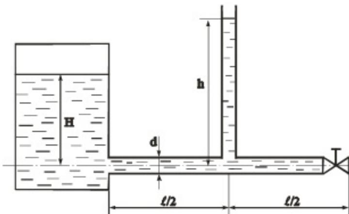
23. Вода (плотность  $\rho=1000$  кг/м<sup>3</sup>) подается в открытый верхний бак по вертикальной трубе ( $d=25$  мм;  $l=3$  м;  $h=0,5$  м) за счет избыточного давления  $P_m$  в нижнем закрытом баке. Определить давление  $P_m$ , при котором расход будет равен  $Q=1,5$  л/сек. Коэффициент сопротивления вентиля  $\xi_v=9$ . Трубу считать гидравлически гладкой. Учесть сопротивления на входе в трубу и на выходе из нее. Вязкость протекающей жидкости  $v = 1 \cdot 10^{-6}$  м<sup>2</sup>/с
