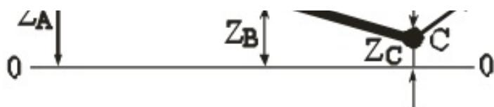
18. Вода по трубе Т попадает в бак А в количестве  $Q=10 \text{ л/с}$ . Далее вода из бака А поступает в бак Б через внешний цилиндрический насадок диаметром  $d=50 \text{ мм}$  ( $\mu_{\text{ц}}=0,82$ ), а затем через трубу того же диаметра  $d$  и длиной  $l=2 \text{ м}$  вытекает в атмосферу. Принять коэффициент гидравлического трения  $\lambda=0,03$ . Определить перепад  $h$  уровней воды в резервуарах, а также уровень  $H$  в резервуаре Б.
