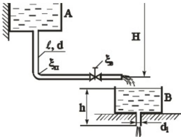
14. Наполнение бассейна из магистрали с заданным давлением  $P_m=2,5 \text{ кгс/см}^2$  производится по горизонтальной трубе, снабженной вентилем ( $\xi_B=4$ ) и отводом ( $\xi_{\pi}=0,3$ ). Определить диаметр трубопровода, который обеспечит наполнение бассейна объемом  $W=36 \text{ м}^3$  за время  $t=30 \text{ мин}$ . Потерями по длине пренебречь.  $\gamma=9810 \text{ Н/м}^3$ .
