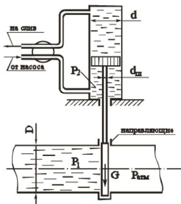
8. На рисунке представлена схема главного тормозного цилиндра автомобиля в момент торможения. Определить силу  $F$ , которую необходимо приложить к педали тормоза, что-бы давление в рабочих цилиндрах передних колес было  $P_1=6$  МПа. Каким при этом будет давление в рабочих цилиндрах задних колес  $P_2$ ? При расчете принять: усилие пружины 1 принять  $F_1=100$  Н, пружины 2 принять  $F_2=150$  Н, диаметр цилиндра  $D=20$  мм, плечи  $a=60$  мм,  $b=180$  мм. Силами трения пренебречь.
