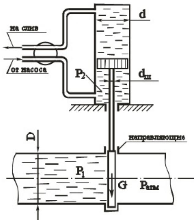
38. На рисунке представлена схема главного тормозного цилиндра автомобиля в момент торможения. Определить силу  $F$ , которую необходимо приложить к педали тормоза, чтобы давление в рабочих цилиндрах передних колес было  $P_1=6$  МПа. Каким при этом будет давление в рабочих цилиндрах задних колес  $P_2$ ? При расчете принять: усилие пружины 1 принять  $F_1=100$  Н, пружины 2 принять  $F_2=150$  Н, диаметр цилиндра  $D=20$  мм, плечи  $a=60$  мм,  $b=180$  мм. Силами трения пренебречь.
