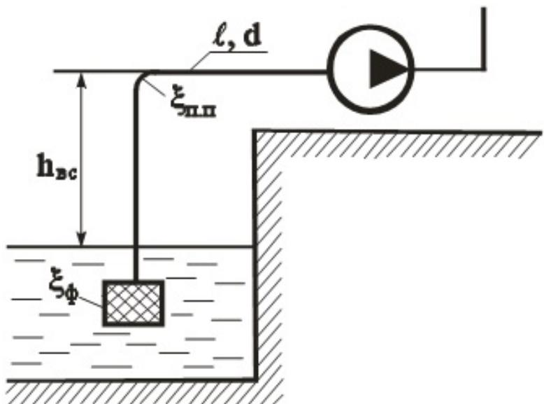
53. Выбрать марку насоса, обеспечивающего заполнение резервуара объемом  $W=4$  м<sup>3</sup> за время  $t=3,5$  мин, если геометрическая высота подъема  $H_g=10$  м, длина всасывающей линии  $l_{bc}=10$  м, диаметр  $d_{bc}=100$  мм, коэффициент  $\lambda=0,02$ , потери на местные сопротивления равны 15% от потерь по длине. Длина нагнетательной линии  $l_h=550$  м,  $d_h=100$  мм,  $\lambda=0,02$ . Местные потери  $h_m=20\%$  от  $h_l$ .
