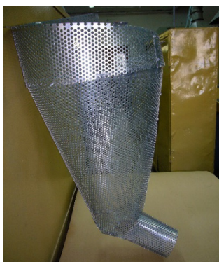
Рисунок 2 – Лабораторный циклон-сепаратор молотковой дробилки зерна с круглыми отверстиями в сепарирующем решете
