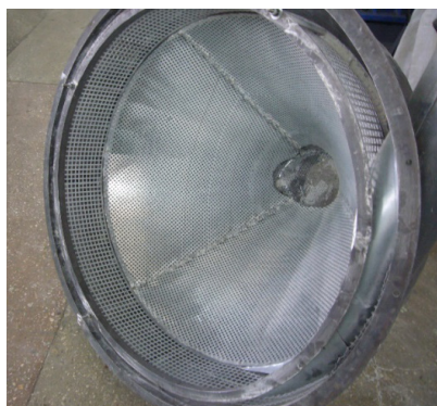
Рисунок 3 – Лабораторный циклон-сепаратор молотковой дробилки зерна с квадратными отверстиями в сепарирующем решете
