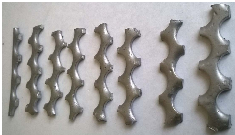
Рисунок 3 – Фрагменты сепарирующего решета, подготовленные для измерения износа перемычек между отверстиями
