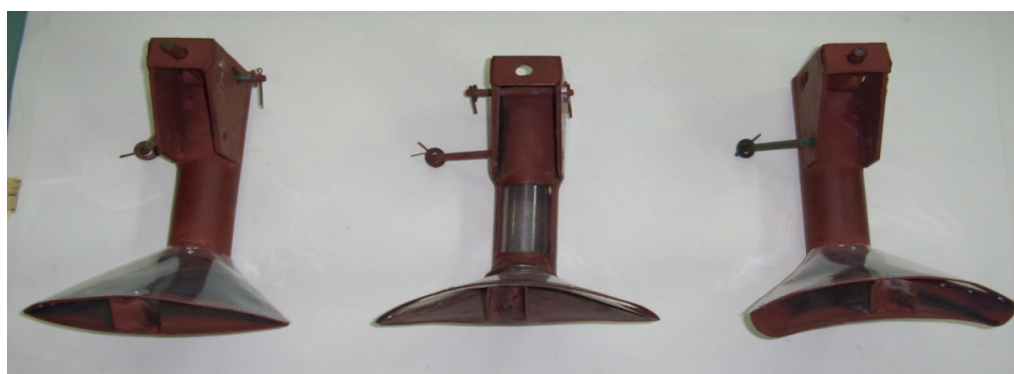
Рисунок 4 – Распределители семян с различной кривизной распределяющей пластины: 0 (1); 2,8 (2); 5,6 (3)
