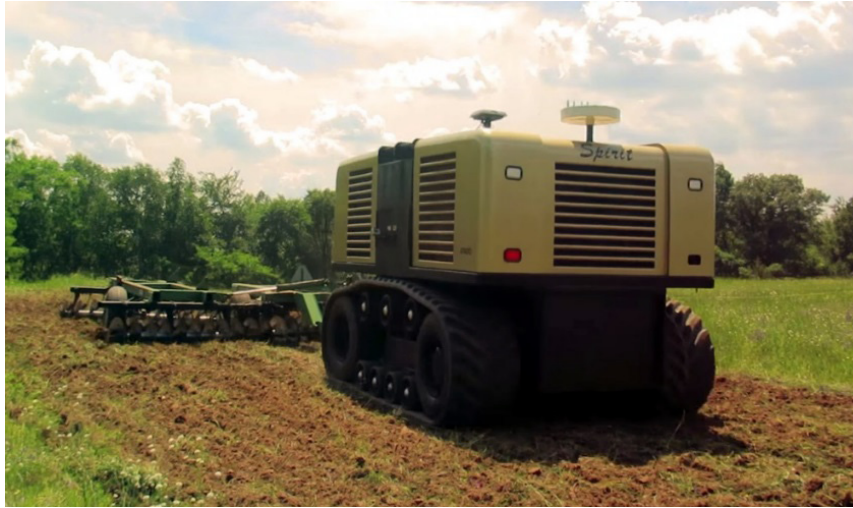
Рисунок 1 – Предполагаемый внешний вид универсального сельскохозяйственного транспортного модуля для роботизированных систем по уходу за растениями
