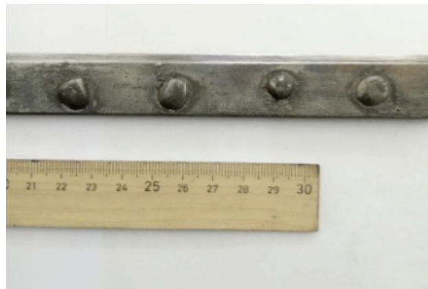
Рисунок 3 – Стальная основа с точками, наплавленными электродами Т-590, ЦЛ-11, МР-3С
