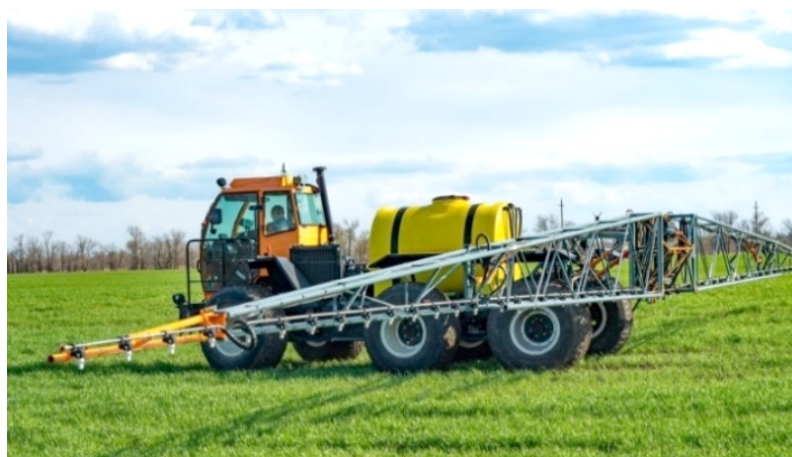
Рисунок 1 – Агрегаты фирмы «Пегас-Агро» для агрохимических работ в земледелии: а) мультиинжектор «Туман-2М»; б) опрыскиватель штанговый «Туман-2»
