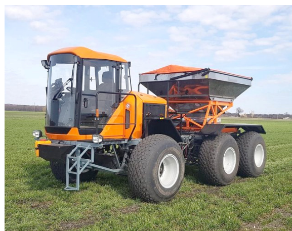
Рисунок 5 – Многофункциональные самоходные комплексы «Туман» ООО «Пегас-Агро»:
