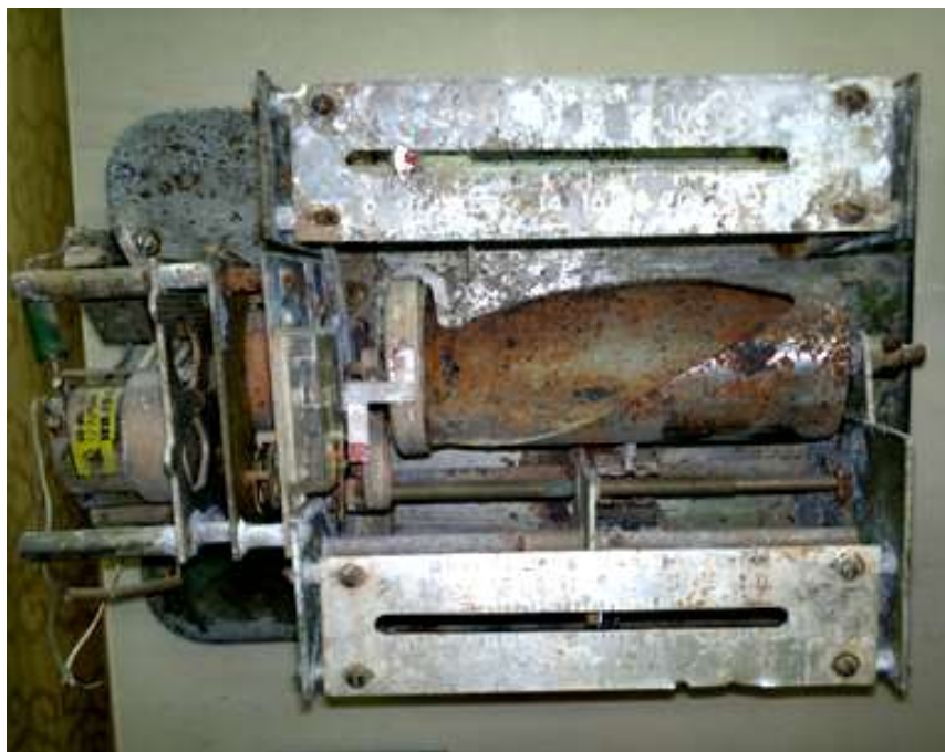
Рисунок 3 – Программное устройство управления освещением в птичнике РУС-3
