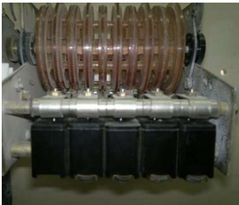
Рисунок 4 – Программное устройство управления освещением в птичнике КЭ
