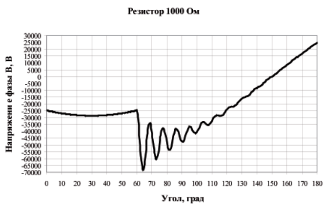
Рисунок 6 – Форма кривой напряжения фазы В при угле 60° замыкания фазы А
