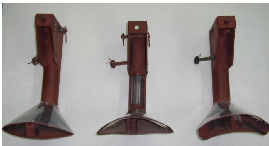
Рисунок 2 - Распределители семян с различной формой кривизны отражающей пластины: 1 – прямая; 2 – слегка изогнутая; 3 – сильно изогнутая.
