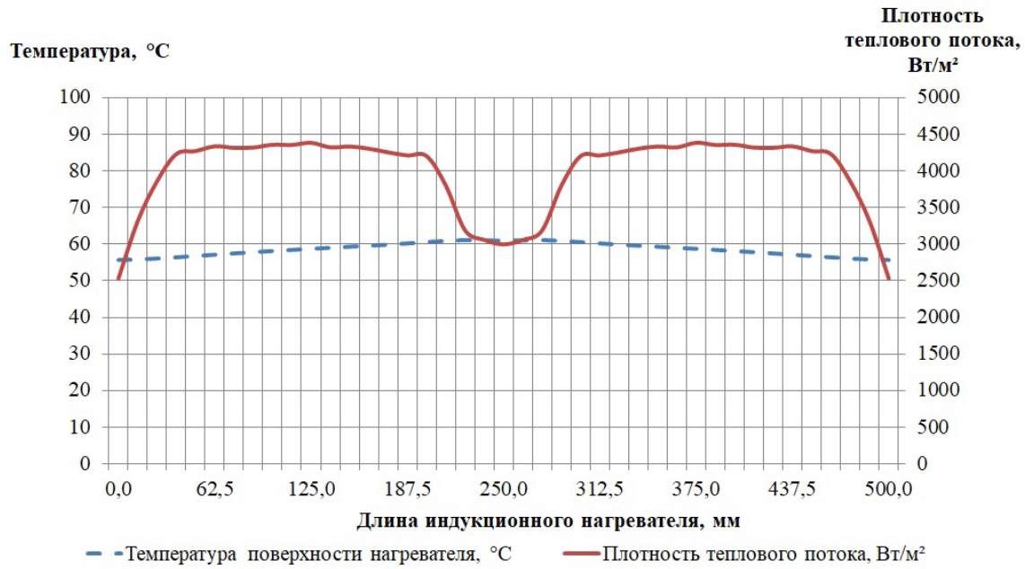
Рисунок 4 – Распределение температуры и плотности теплового потока по длине плоского индукционного водонагревателя
