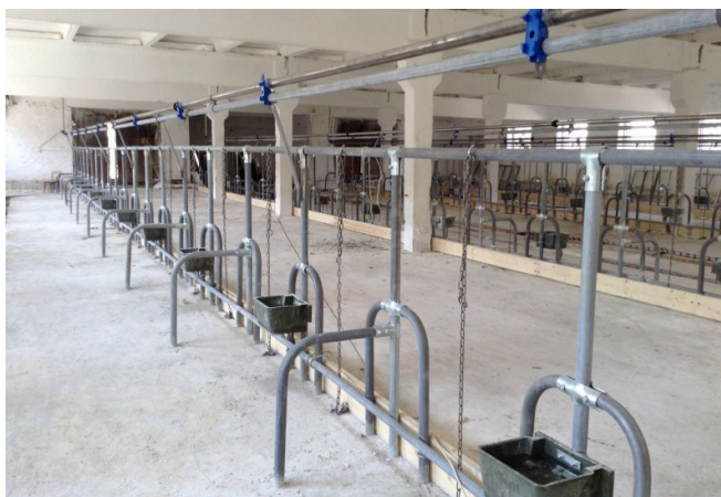
Рисунок 1 – Использование толстостенной оцинкованной вакуумной трубы ДУ40 гарантия надежной работы молокопровода: трубы не провиснут через полгода
