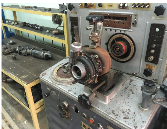
Рисунок 1 – Установка турбокомпрессора на лабораторный стенд (а) и его маркировка (б)
