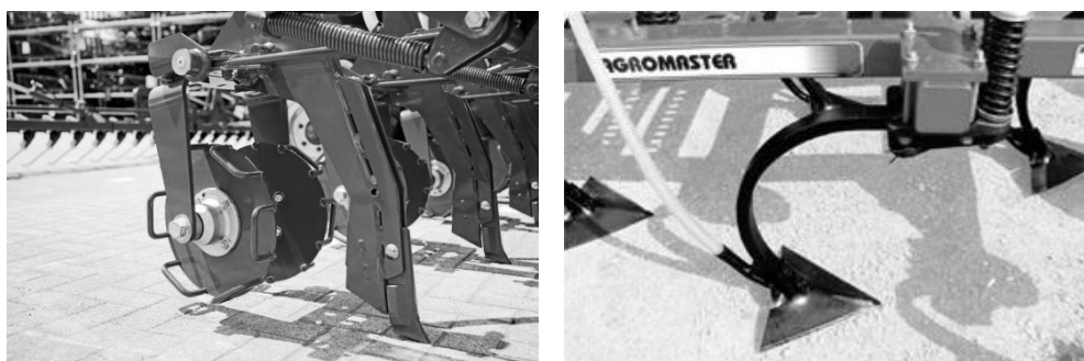
Рисунок 4 – Виды сошников с острым углом вхождения в почву: а – анкерный сошник; б – лаповый сошник
