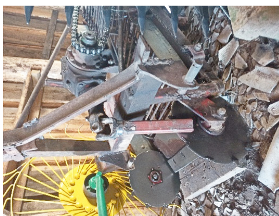
Рисунок 6 – Однорядный картофелекопатель с прутковым элеватором: а – вид спереди; б – рабочие органы
