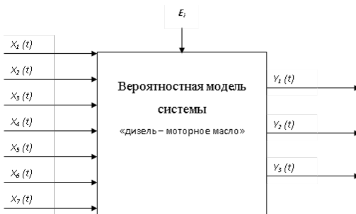
Рисунок 1 – Схема воздействия эксплуатационных факторов на изменение показателей физико-химических свойств масла
