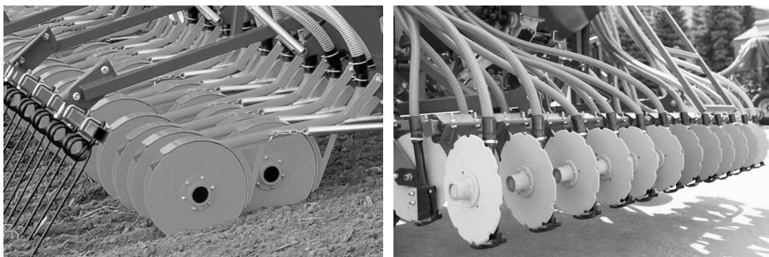
Рисунок 2 – Виды сошников с тупым углом вхождения в почву:
