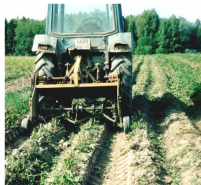
Рисунок 2 – Ботводробитель с горизонтальной осью вращения и различными рабочими органами:
