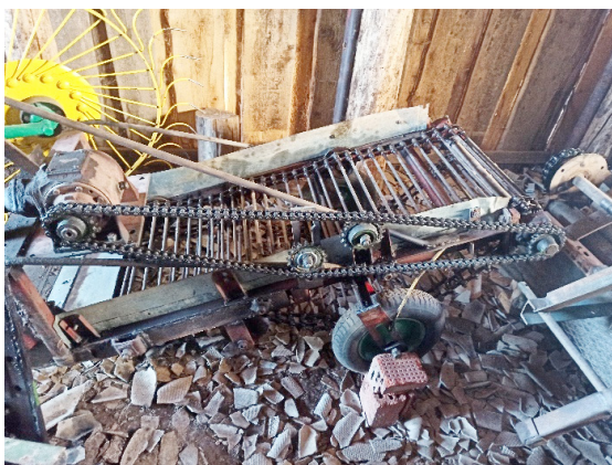
Рисунок 6 – Однорядный картофелекопатель с прутковым элеватором: а – вид спереди; б – рабочие органы
