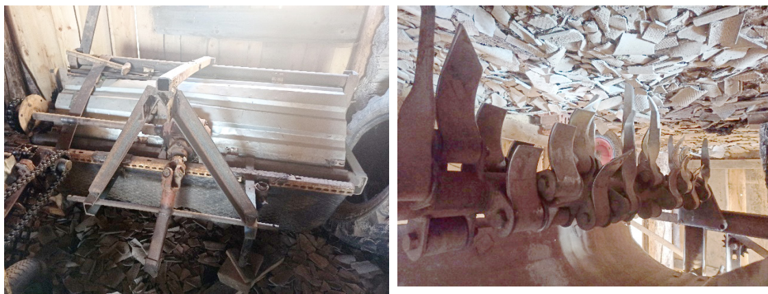
а б Рисунок 5 – Ротационный ботвоудалитель: а – вид спереди; б – рабочие органы
