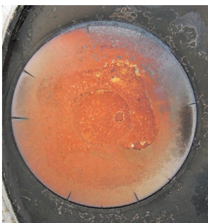
Рисунок 4 – Трещины на головке клапана
